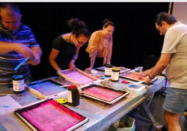
La Sérigraphie est une technique d'imprimerie qui utilise des pochoirs interposés entre l'encre et le support. Les supports utilisés peuvent être variés.
